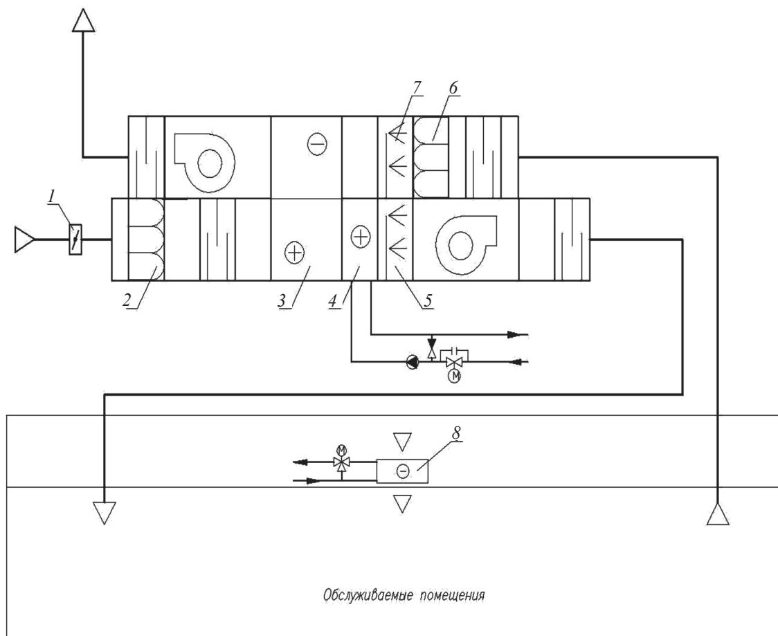
1 – клапан; 2 – воздушный фильтр; 3 – роторный утилизатор; 4 – воздухонагреватель;
