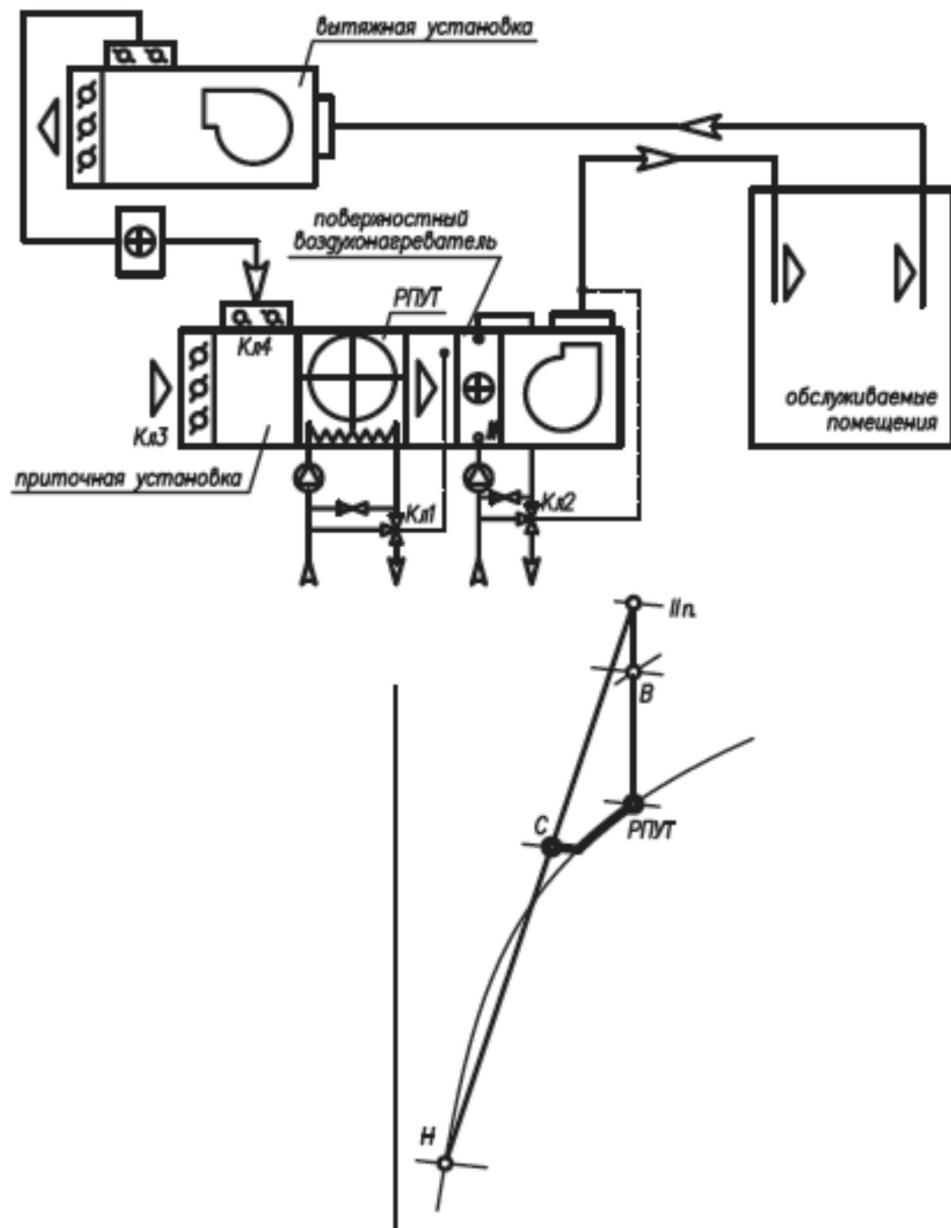
Рисунок 10.3 – Схема с подогревом рециркуляционного воздуха
