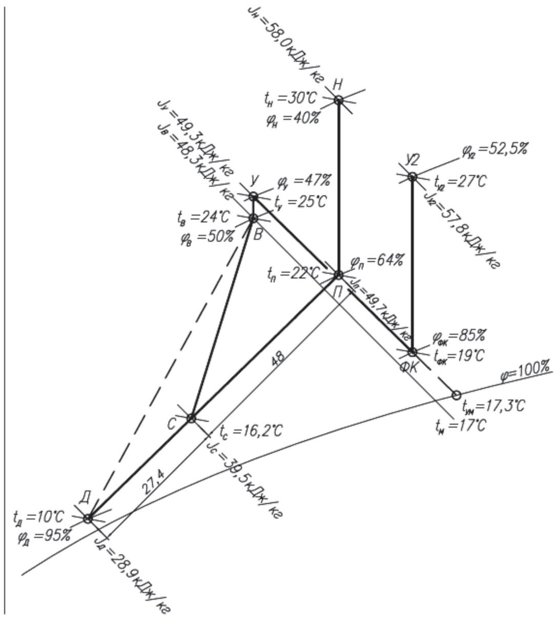
Рисунок 8.6 – J-d диаграмма процессов обработки воздуха в схеме систем
