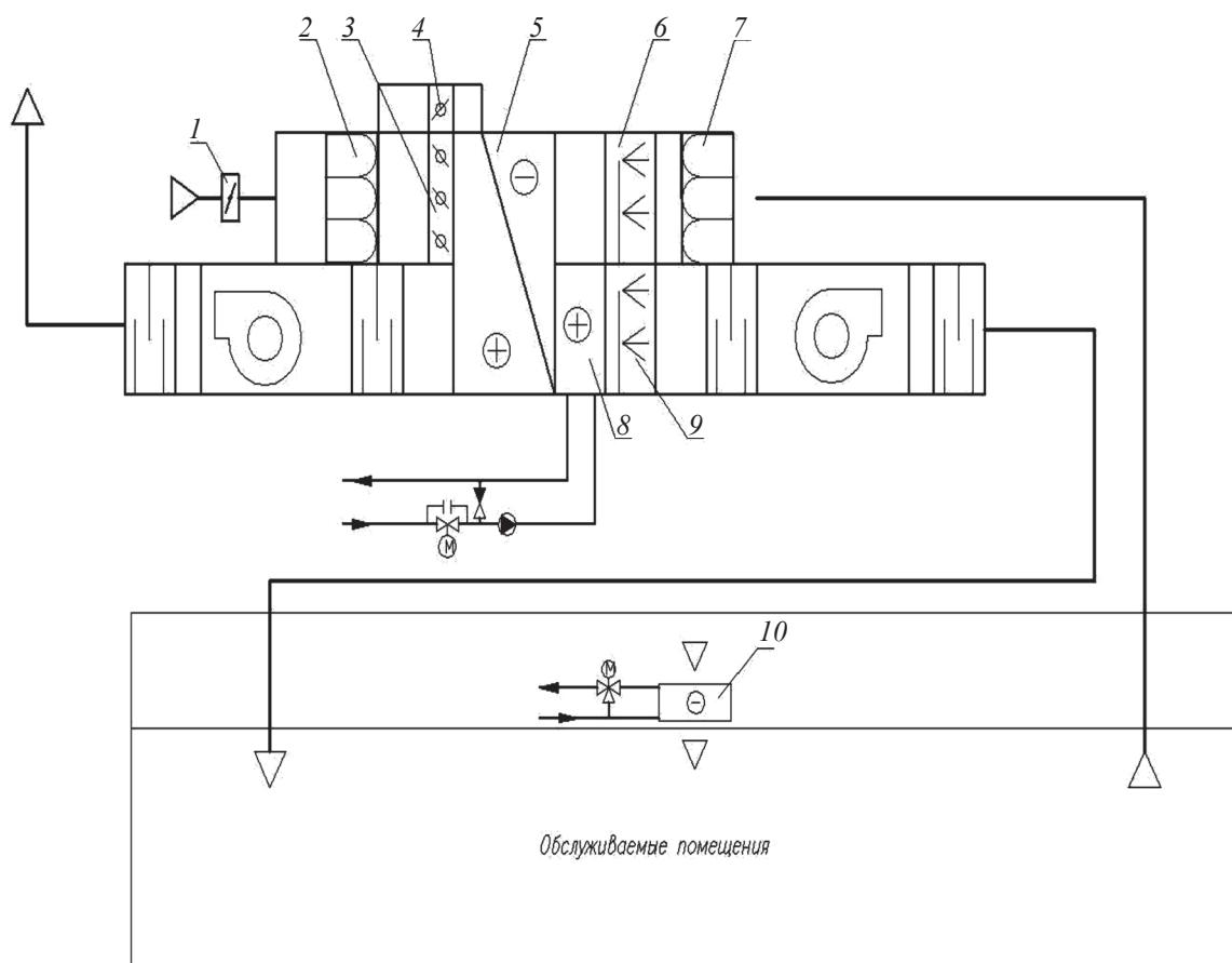
1 – клапан; 2 – воздушный фильтр; 3,4 – клапаны обводного канала; 5 – пластинчатый теплообменник «воздух-воздух»; 6 – адиабатический увлажнитель (вытяжной воздух); 7 – воздушный фильтр; 8 – воздухонагреватель (приточный воздух); 9 – адиабатический увлажнитель (приточный воздух); 10 – местный доводчик
