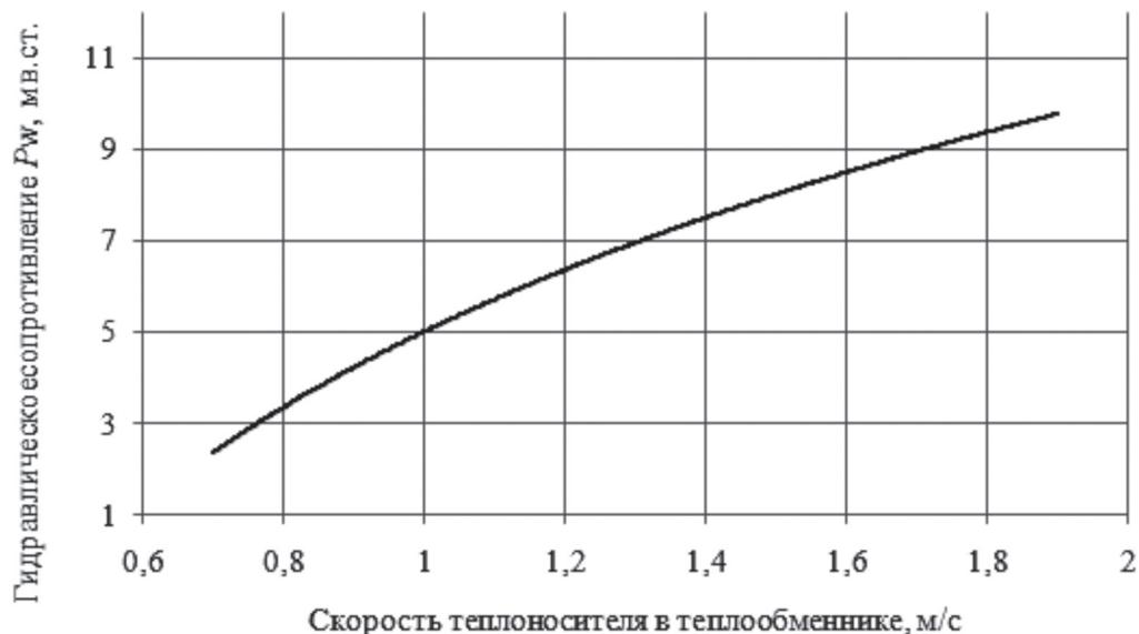
Рисунок 10.12 – Зависимость гидравлического сопротивления РПУТЗ
