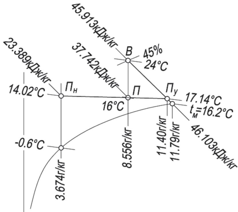
Рисунок 6.4 – Определение граничных параметров наружного воздуха
