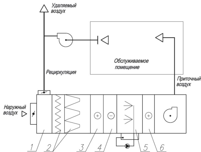
1 – рециркуляционная камера; 2 – фильтры; 3 – воздухонагреватель I подогрева;
