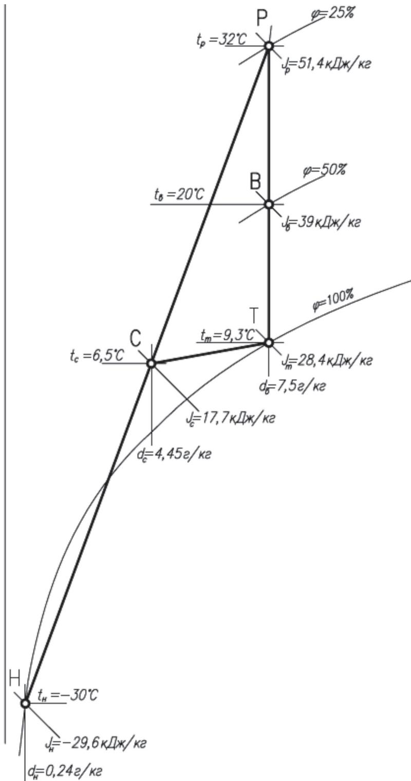
Рисунок 11.5 –  $J$ - $d$  диаграмма процессов обработки воздуха в холодный период года в схеме системы кондиционирования с постоянной первой рециркуляцией при минимальной температуре наружного воздуха
