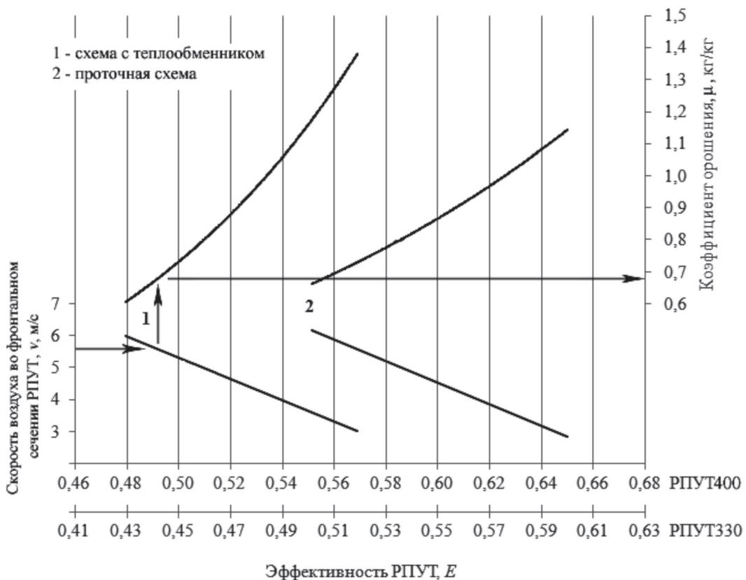
Рисунок 10.16 – Определение коэффициента орошения
