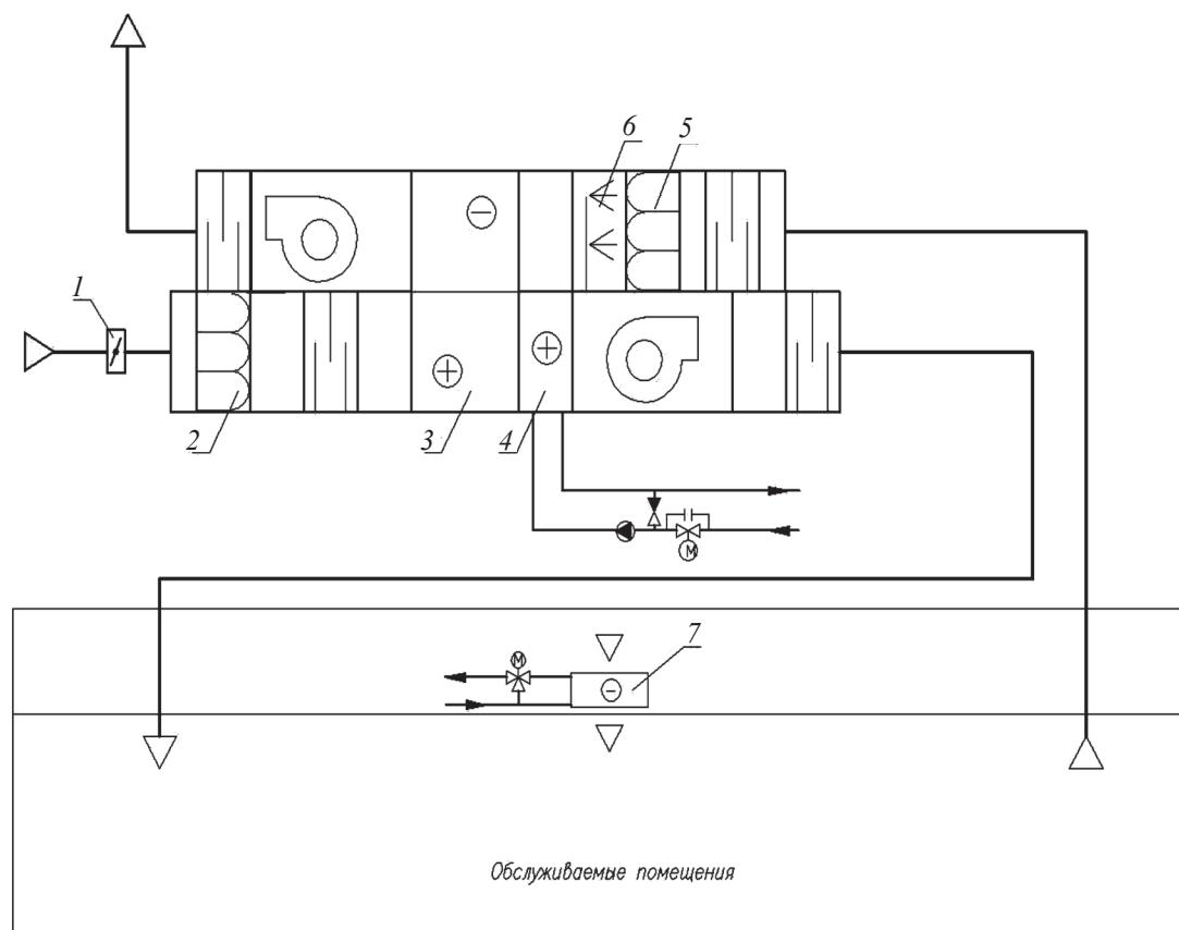
1 – клапан; 2 – воздушный фильтр; 3 – роторный утилизатор; 4 – воздухонагреватель;
