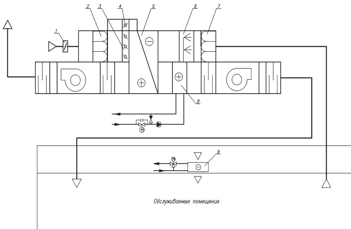
1 – клапан; 2 – воздушный фильтр; 3,4 – клапаны обводного канала; 5 – пластинчатый теплообменник «воздух-воздух»; 6 – адиабатический увлажнитель (вытяжной воздух); 7 – воздушный фильтр; 8 – воздухонагреватель (приточный воздух); 9 – местный доводчик
