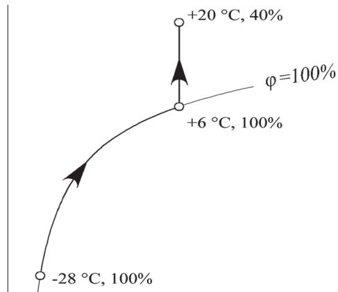
Рисунок 10.15 – Процесс обработки воздуха на *J-d* диаграмме
