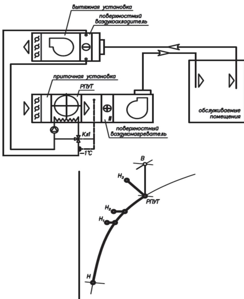
Рисунок 10.1 – Принципиальная схема прямоточного типа
