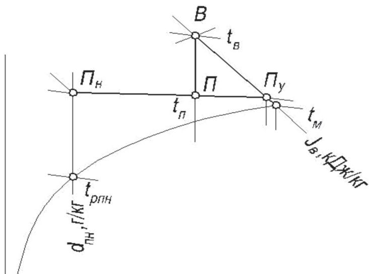
Рисунок 6.2 – Процесс определения граничного состояния наружного воздуха
