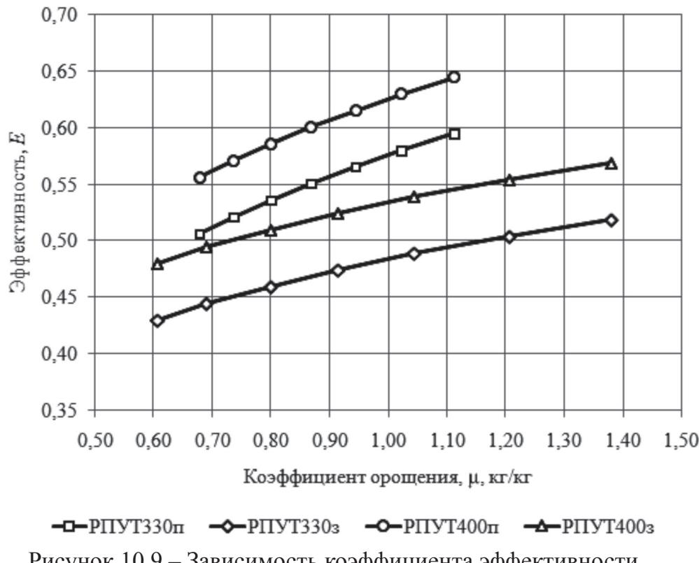
Рисунок 10.9 – Зависимость коэффициента эффективности от коэффициента орошения РПУТ
