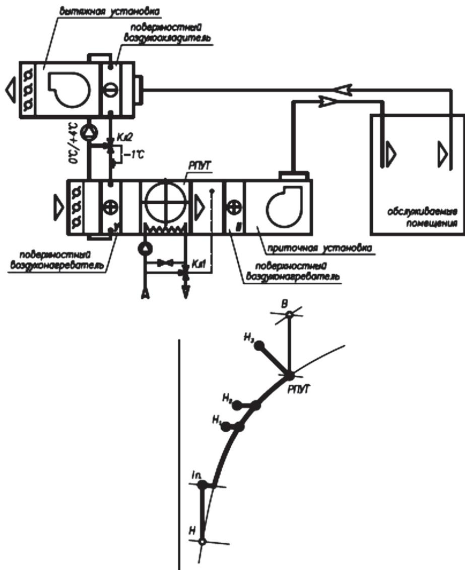
Рисунок 10.2 – Схема прямоточного типа с использованием предподогрева
